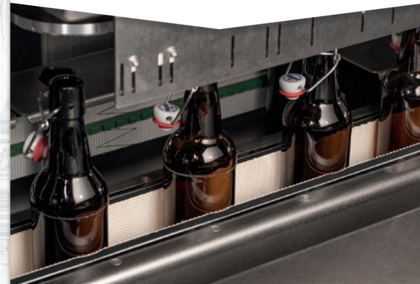
MIHO, es una empresa alemana situada en el norte de Hesse, es uno de los principales fabricantes de sistemas de inspección de botellas en vacío. Sistemas controlados por cámaras, había problemas con el recubrimiento de las correas de transporte, absorbían demasiada humedad y provocaban una contaminación bacteriológica. En colaboración con Optibelt se diseñó un recubrimiento tipo (sandwich) con espuma de neopreno y pvc. Con el paso del tiempo la solución ha sido óptima.
