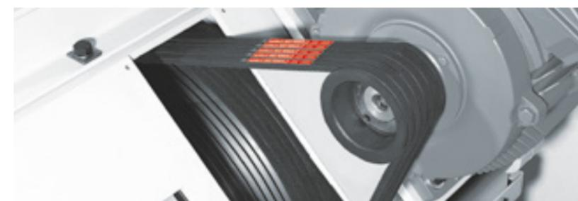
Elemento de transmisión en una prensa paletizadora para producir forraje
